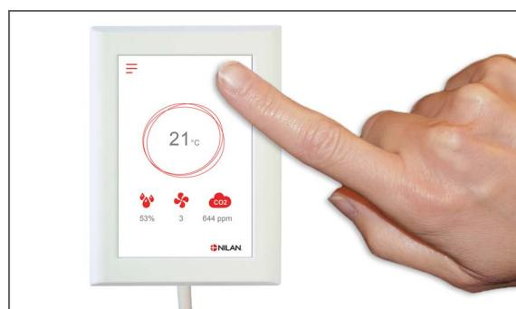
8. Tænd for ventilationsaggregatet igen. Tryk på Alarm ikonet for at nulstille filteralarmen.
